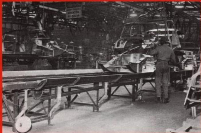
1. Sur ce chariot est déposé l'ensemble du caisson : unit-avant, unit-arrière et plancher. Le chariot, placé sur un carrousel (comportant 17 chariots), progresse automatiquement, et passe sur trois soudeuses multipoints entièrement automatiques.
