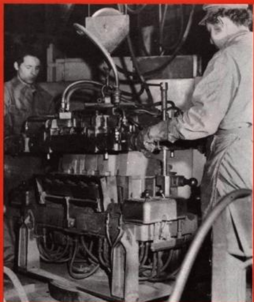
▲ L'ensemble des noyaux est ensuite agrippé et déposé dans la partie inférieure du moule.
