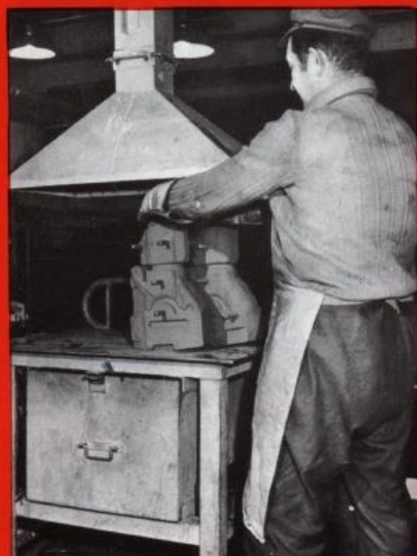
La mise en place des noyaux est complexe. Elle est réalisée sur un montage (ou faux moule).
