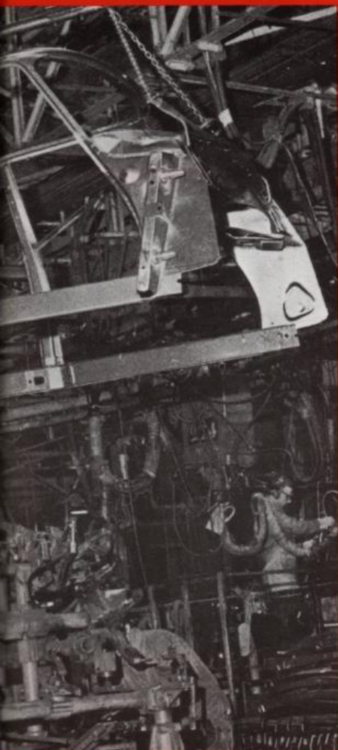
1. Sur ce chariot est déposé l'ensemble du caisson : unit-avant, unit-arrière et plancher. Le chariot, placé sur un carrousel (comportant 17 chariots), progresse automatiquement, et passe sur trois soudeuses multipoints entièrement automatiques.
