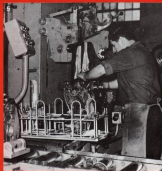
3. Le départ des culasses vers le carrousel : avant tout, elles sont lavées, rincées, séchées dans une machine à laver entièrement automatique. Puis on les habille...
