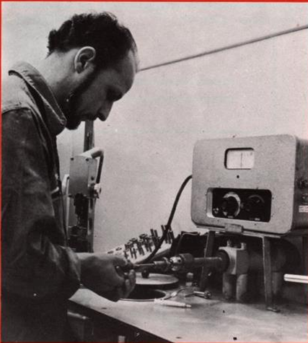
5. Dans cet atelier climatisé (20 à 23°C), sont préparés les « étalons » qui servent au contrôle des pièces qui auront à coulisser entre elles (exemple : chemises et tiroirs). L'outilier rôte son étalon avec de la poussière de diamant. Sur l'écran de l'appareil de mesure, une graduation représente 1/10 de micron.
