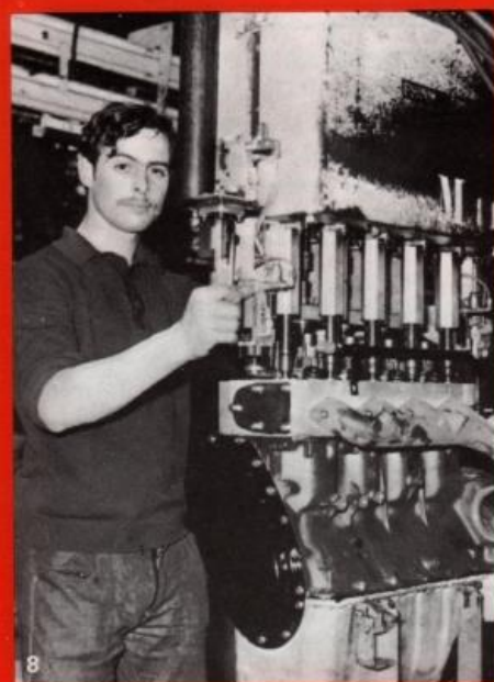
8. Les culasses demandent une étanchéité parfaite : on emploie pour les fixer une serreuse multiple à air comprimé dont l'action est plus efficace que celle de la serreuse électrique.
