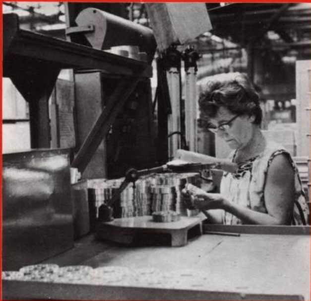
4. En fin d'usinage, le contrôle : la pièce doit être précise, au 1/100 de millimètre, près. Entre le palier et le corps de pompe, l'étanchéité doit être parfaite. Placés dans des paniers conçus spécialement pour les recevoir, les corps de pompe gagnent le secteur de montage où ils rejoignent les autres éléments composant la pompe.
