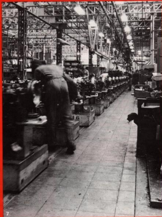
8. Les culasses demandent une étanchéité parfaite : on emploie pour les fixer une serreuse multiple à air comprimé dont l'action est plus efficace que celle de la serreuse électrique.
