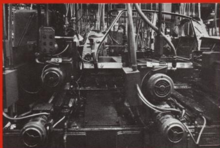
3. Le carrousel d'as- semblage du haut de caisse compte six cha- riots portant des ma- quettes très précises. Quatorze soudeurs réa- lisent ensemble 278 points de soudure sur chaque haut de caisse.
