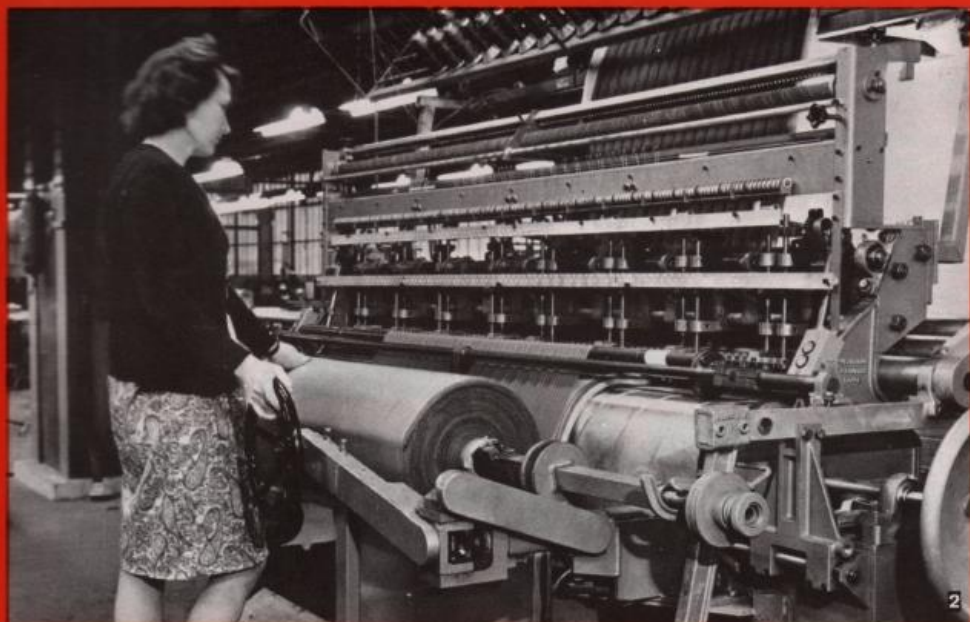
2. Une machine à piquer les côtes (tissu et mousse ensemble) : elle s'arrête lorsqu'un fil casse. Elle est armée de 25 aiguilles et débite 75 mètres à l'heure.
