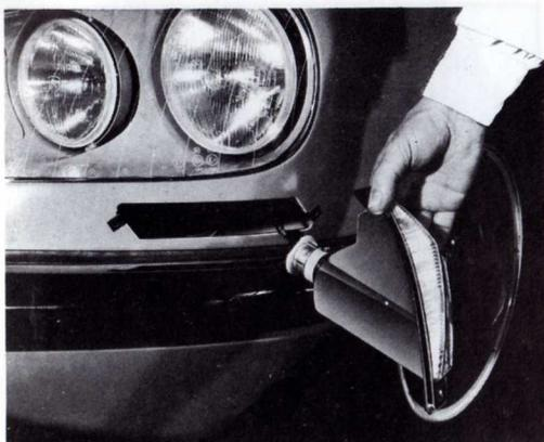
Fig. 40 - Indicateurs de direction avant.
