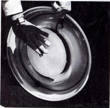
Fig. 33 - Démontage de l'enjoliveur de roue
