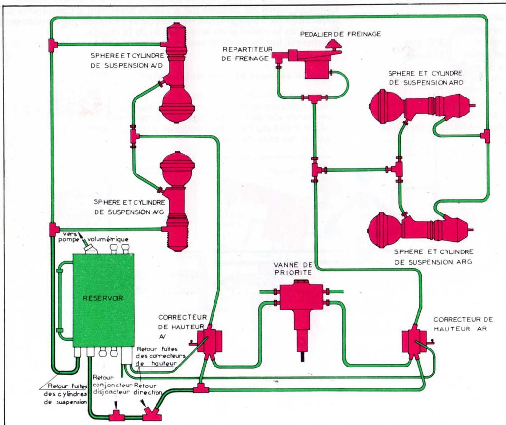
Fig. 49 - circuit hydraulique de la suspension
