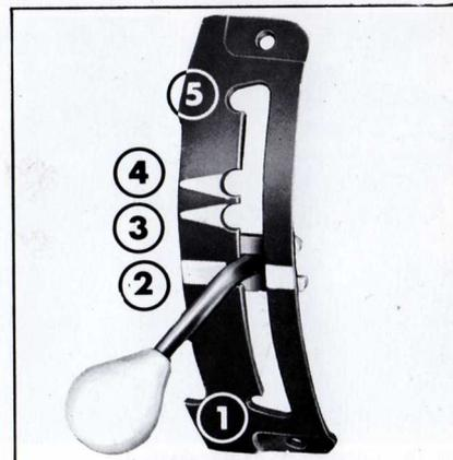
Fig. 16 - Réglage de la garde au sol
