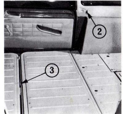
Fig. 10 - Banquette arrière escamotable
