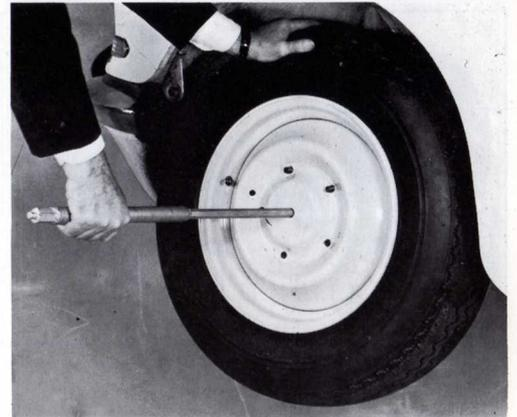
Fig. 35 - Guidage de la roue au remontage
