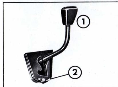
Fig. 17 - Commande de blocage de frein de secours
