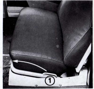
Fig. 9 - Banquette arrière escamotable
