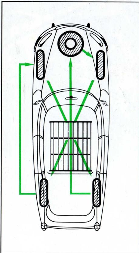
Fig. 28 - Permutation des pneumatiques
