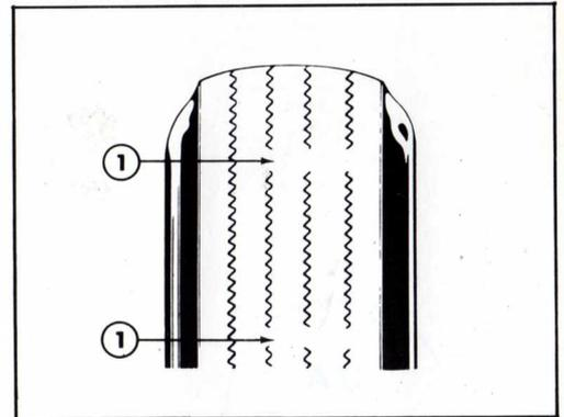
Fig. 29 - Témoins d'usure des pneumatiques
