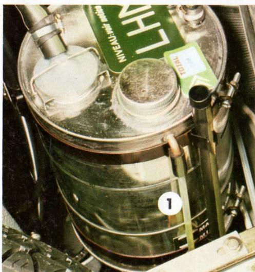
Fig. 26 - Réservoir de l'installation hydraulique
