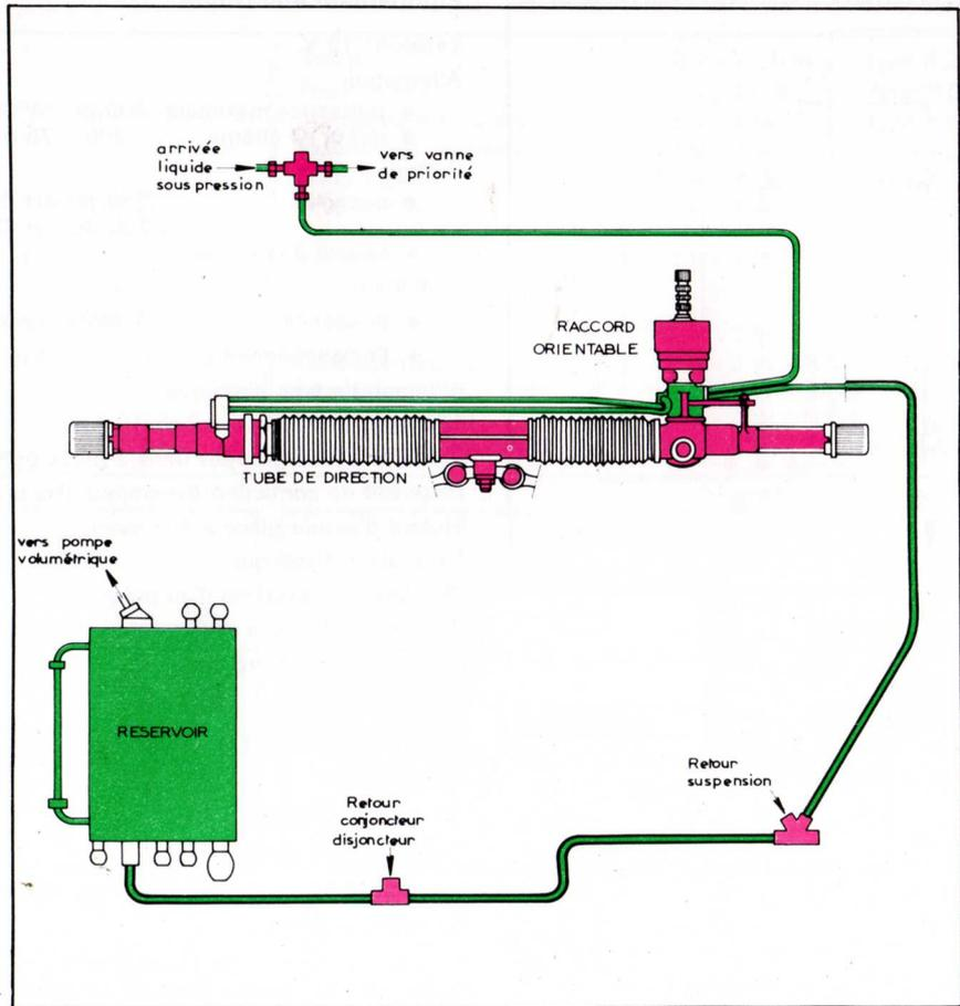
Fig. 53 - Circuit hydraulique de la direction
