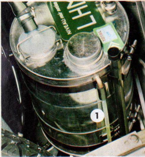
Fig. 26 - Réservoir de l'installation hydraulique
