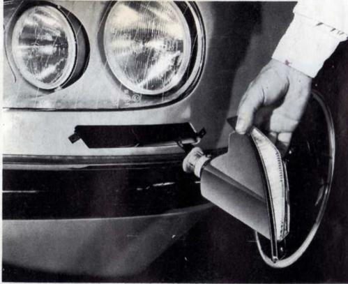
Fig. 40 - Indicateurs de direction avant
