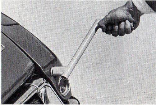
Fig. 32 - Démontage d'une aile arrière
