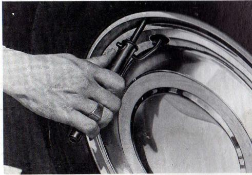
Fig. 33 - Démontage de l'enjoliveur de roue
