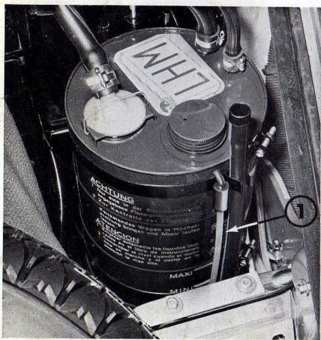
Fig. 26 - Réservoir de l'installation hydraulique
