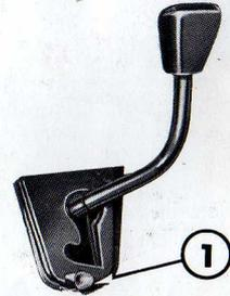
Fig. 17 - Commande de blocage de frein de secours
