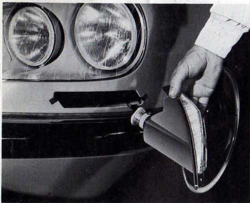
Fig. 40 - Indicateurs de direction avant
