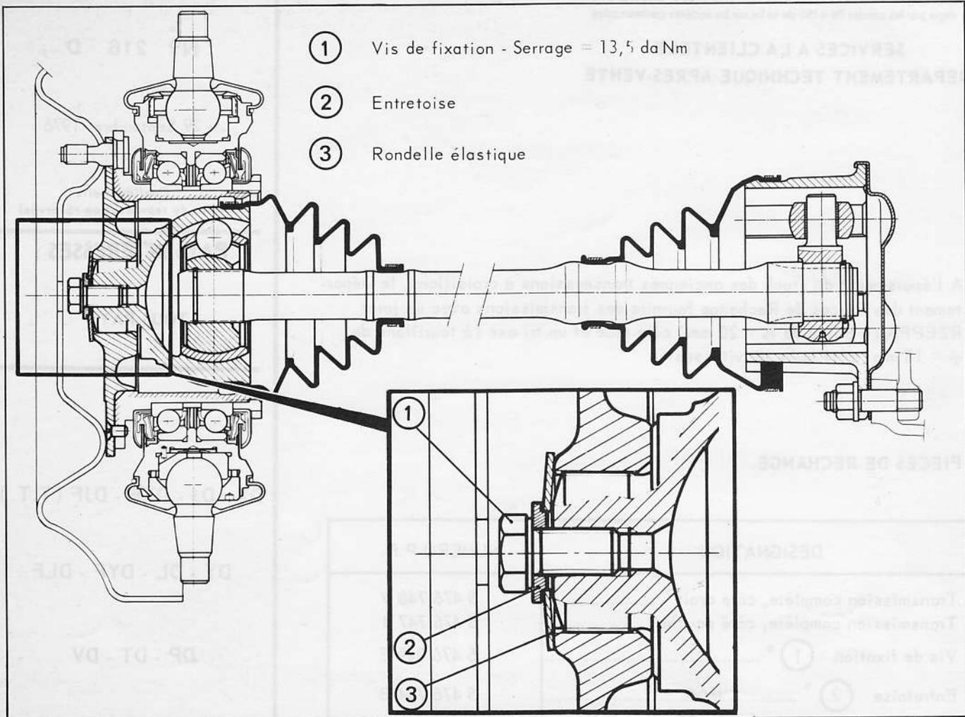
REMARQUE : Pour les véhicules DX, DJ, DXF et DJF, les étouffeurs de vibrations des anciennes transmissions doivent être remplacés sur les nouvelles, et positionnés suivant les schémas ci-dessous.
