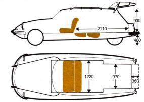
de véhicule : longueur 2,11 m, largeur 1,22 m dans la partie médiane, 0,97 m dans le compartiment arrière. Soit une surface utilisable de 2,30 m², accessible par la porte arrière et par les portières latérales.
