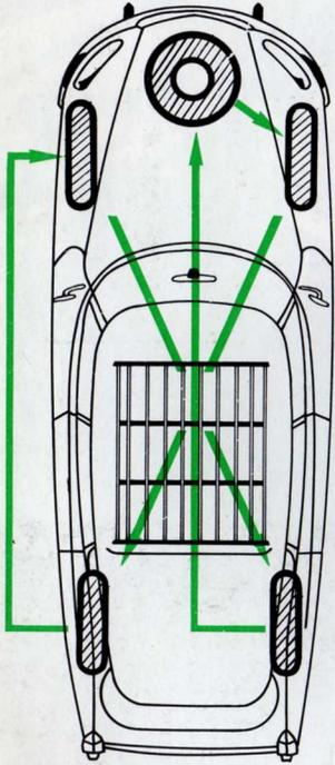
Fig. 28 - Permutation des pneumatiques
