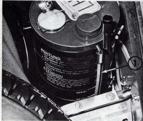
Fig. 26 - Réservoir de l'installation hydraulique
