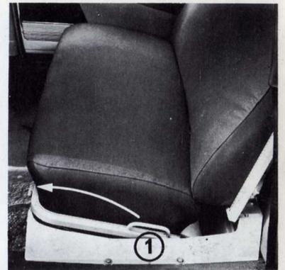
Fig. 9 - Banquette arrière escamotable
